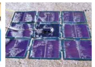
30,000時間 (3年以上) の屋外暴露試験 厳しい気象条件下でも使用可 (雨・海・高温多湿・極寒)
