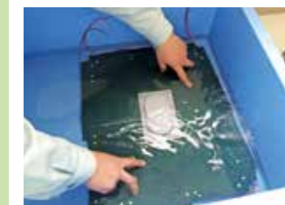
防水試験 IP*57相当の試験を実施 * (International Protection)
